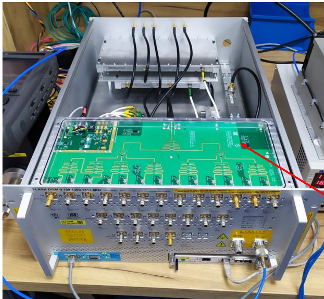
Moduł dystrybucji sygnału wzorcowego w.cz FLASH-DISM w trakcie testów. Widoczny moduł dedykowany dzielnika mocy DIV13.
